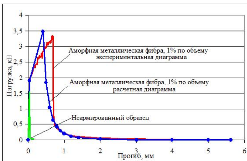
Рис. 2. Расчетная и экспериментальная диаграмма разрушения фибробетона
