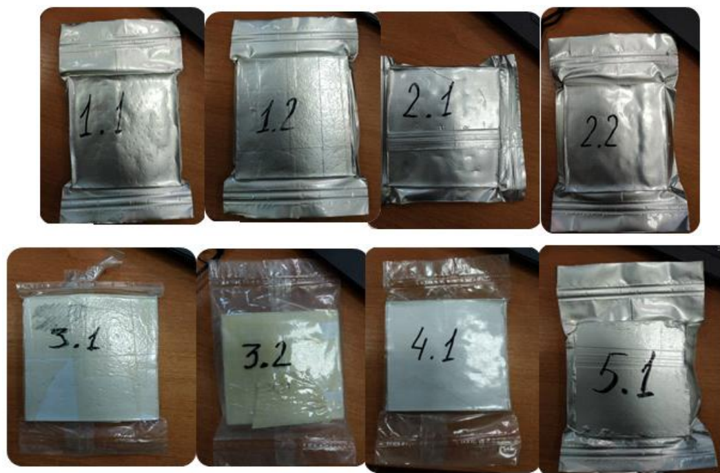
Рис. 3. Образцы исследуемых вакуумных панелей
